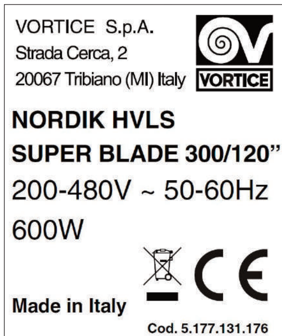
Fig. 1 - esempio targa dati SUPER BLADE 300/120"
